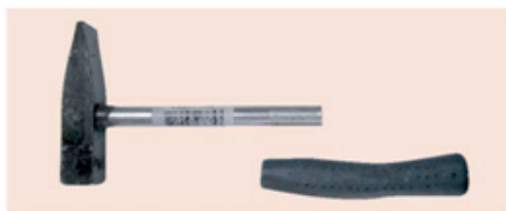
Obrázek 15: hlášení RAPEX č. 0125/06, týkající se kladiva, u nějž došlo ke zlomení rukojeti.
